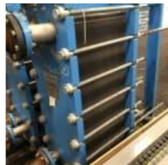
Warmtewisselaars, buis en plaat
